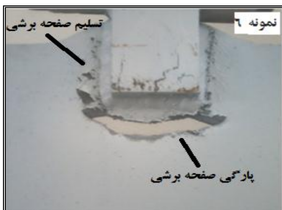
شکل ۷: نمونه‌های ۲ و ۶ در لحظه شکست
