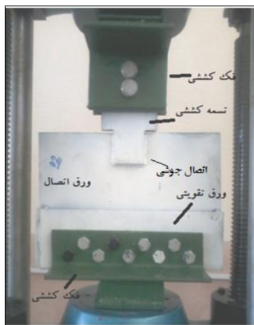
شکل ۲: فک‌های کششی و نمونه ۲ قبل از آزمایش
